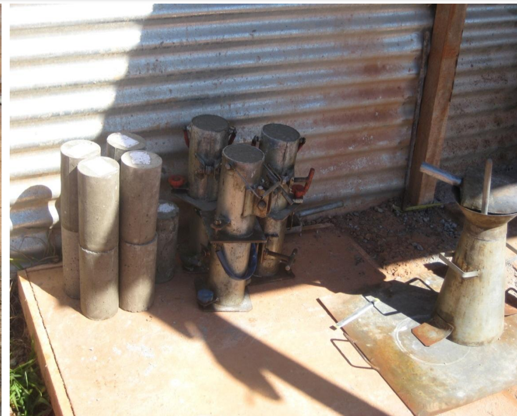
Foto 15 – Ensaio e Moldagem de Corpo de Prova, ref. Item 09.01 do Memorial descritivo
